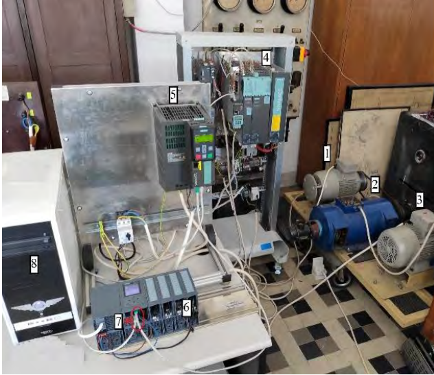
Sl. 5-31 Laboratorijska postavka: 1 – asinhroni motor (pogonska mašina), 2 – DC motor (za opterećenje pri testiranju dinamike motora), 3 – asinhroni motor (za opterećenje pri testiranju u stacionarnim režimima), 4 – SINAMICS S120, 5 – SINAMICS G120, 6 – SIMATIC S7-1500, 7 – PROFINET (Ethernet), 8 – PC
