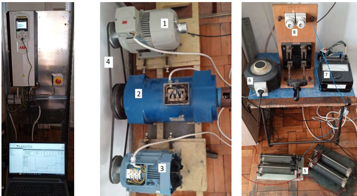
Sl. 5-99 Frekventni pretvarač ABB ACS880-11 sa DTC upravljanjem (levo), mehanički spregnuti motori: 1 – asinhroni motor (AM), 2 – motor za jednosmernu struju (DC motor), 3 – sinhroni reluktantni motor (SynRM), 4 – kaiš (sredina), oprema za dinamičko kočenje DC motora: 5 – otpornici, 6 – autotransformator, 7 – ampermetar (desno), 8 – prekidač (desno).
