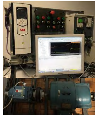
Sl. 5-42 Laboratorijska postavka 2: Frekventni pretvarač (DTC, ABB ACS 880) i DC pogon (ABB DCS 800) – gornja fotografija, AM i DC motor – donja fotografija. Podaci o AM: P_n = 3 \text{ kW} , n_n = 1435 \text{ o/min} , \cos \varphi_n = 0,8 , M_n = 19,97 \text{ Nm} , I_n = 6,5 \text{ A} , U_n = 380 \text{ V} , (Y).
