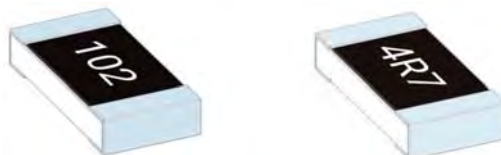
Slika 2.6 Otpornici 1 \text{ k}\Omega i 4.7 \Omega za površinsku montažu.
