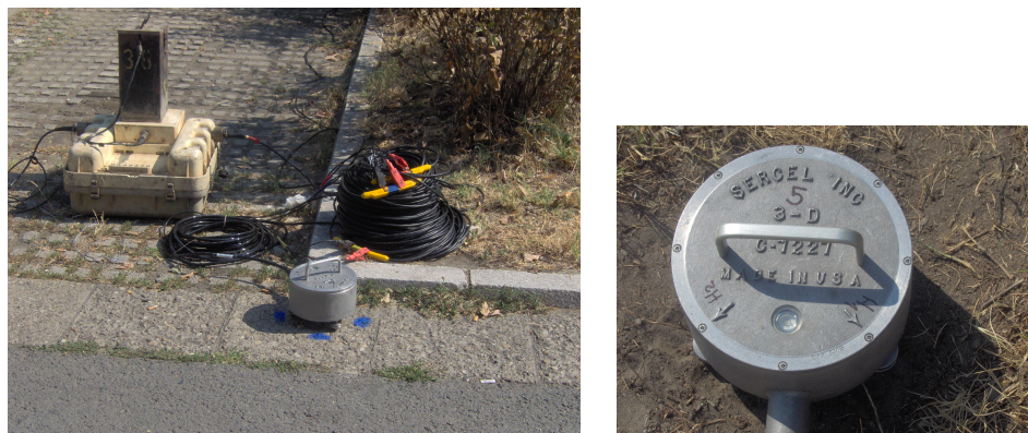
Slika 1.4. Položaj i snimak odozgo geofona L-22-3D/E, SERCEL
