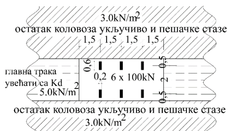
Слика 2. Шема оптерећења за прорачунско возило V600, дата у основи
