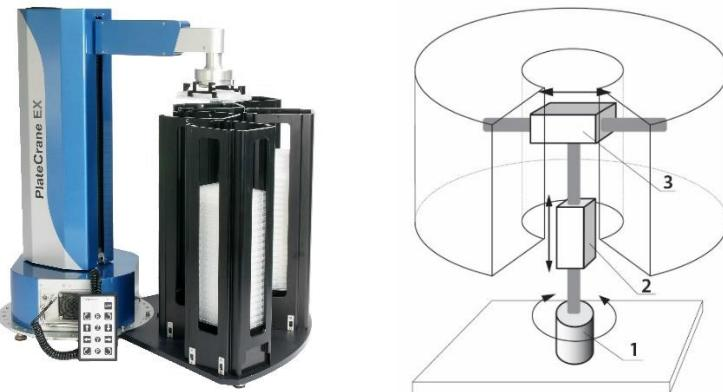
Slika 7 – Cilindrični robot (levo) i njegova minimalna funkcionalna šema (desno) (preuzeto sa: <https://analyticalscience.wiley.com/do/10.1002/gitlab.4177>).
